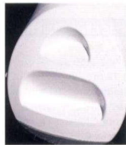
Die GFK-Stufen am Heck sehen zwar chic aus, haben aber keine weitere Funktion
